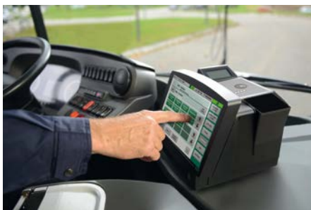
PC-basierter Ticketdrucker und Bordrechner von INIT.
